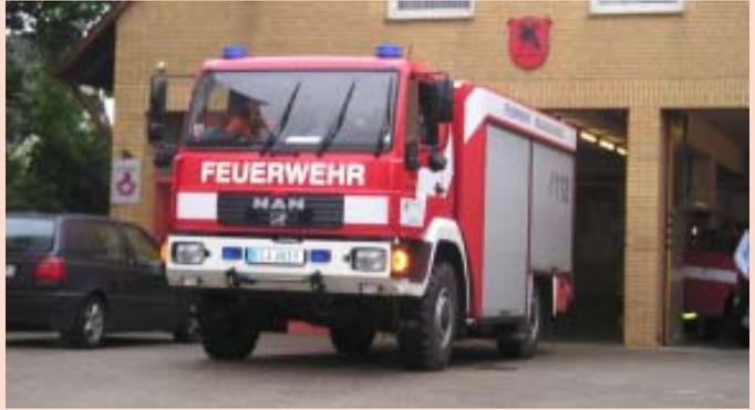
Im Juni bekam die Freiwillige Feuerwehr Mascherode einen neuen Löschzug. Das Tanklöschfahrzeug TLF 16-24T besitzt einen 2500 Liter großen Wassertank, einen eingebauten Feuerlösch-Kreiselpumpe mit einer Leistung von bis zu 2000 Litern pro Minute, eine eigene Stromversorgung sowie einen eingebauten Lichtmast.
