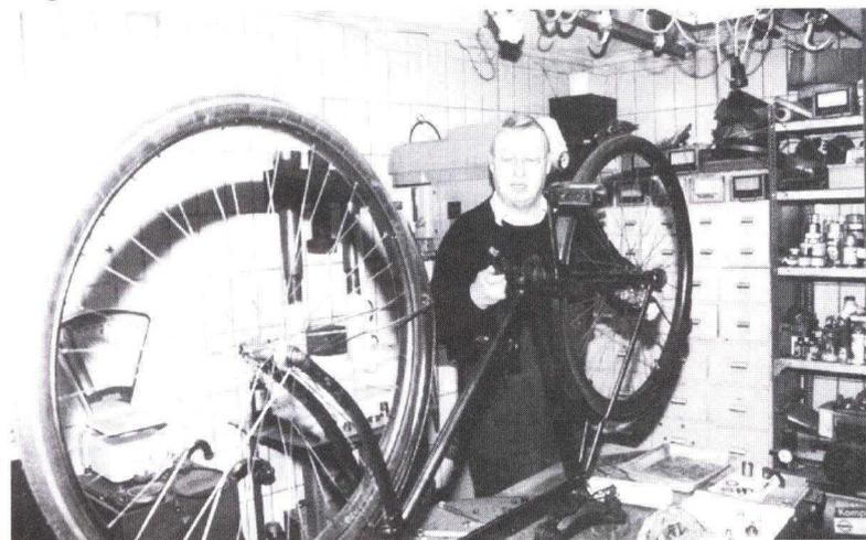
Rainer Uckermann demonstriert den Kardantrieb eines Dürkopp- Fahrrades. Baujahr um 1915.
