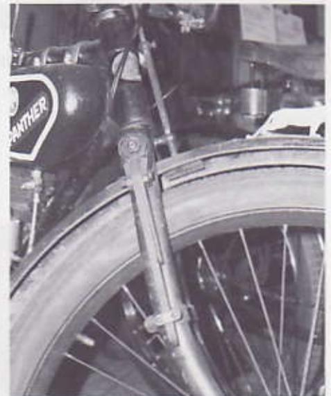
Die Fotos oben zeigen verschiedene Federungssysteme an den Vorderradgabeln von Panther-Mopeds aus der Vorkriegszeit. Rechts im Bild z.B. eine Blattfeder, das älteste Modell.
