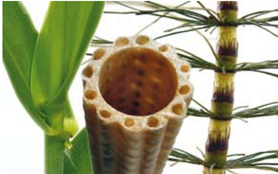
Der „Technische Pflanzenhalm“, ein struktur- und gewichtsoptimiertes bionisches Faserverbundmaterial (Mitte) und zwei der biologischen Ideengeber, Pfahlrohr (links) und Schachtelhalm (rechts).
