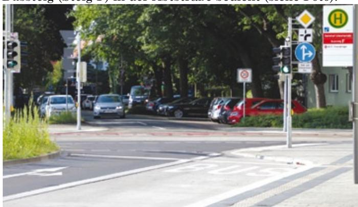
Am Mast der Signalanlage befindet sich ein Ankündigungssignal für die Stadtbahn. Wenn zur Abfahrtszeit noch eine Stadtbahn angekündigt wird, wird sie abgewartet und erst nach der Durchfahrt der Tram 3 wird die Fahrt fortgesetzt. Nach dem Abbiegen wird die kombinierte Bus-Stadtbahn-Haltestelle (Steig A) ebenfalls bedient, um Fahrgäste aufzunehmen.
