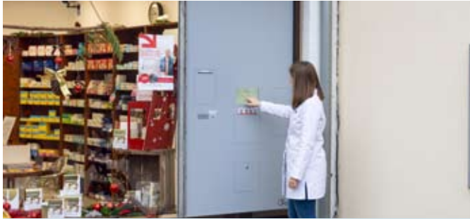
Nach Eingabe eines persönlichen Nummerncodes erhalten die Kundinnen und Kunden Ihre Bestellung aus dem Automaten.
